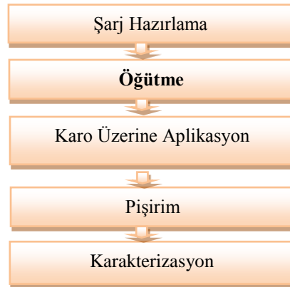
Şekil 2.2. Sır Üretim ve Uygulama Süreci
