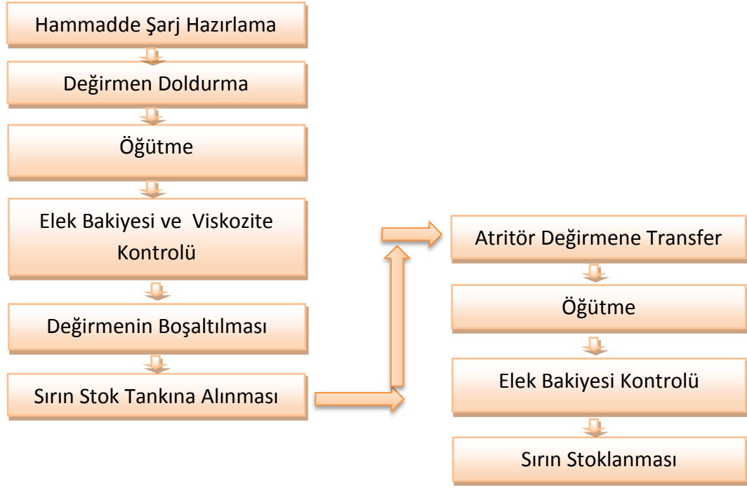
Şekil 4.2. Sır Hazırlama Süreci İş Akışı
