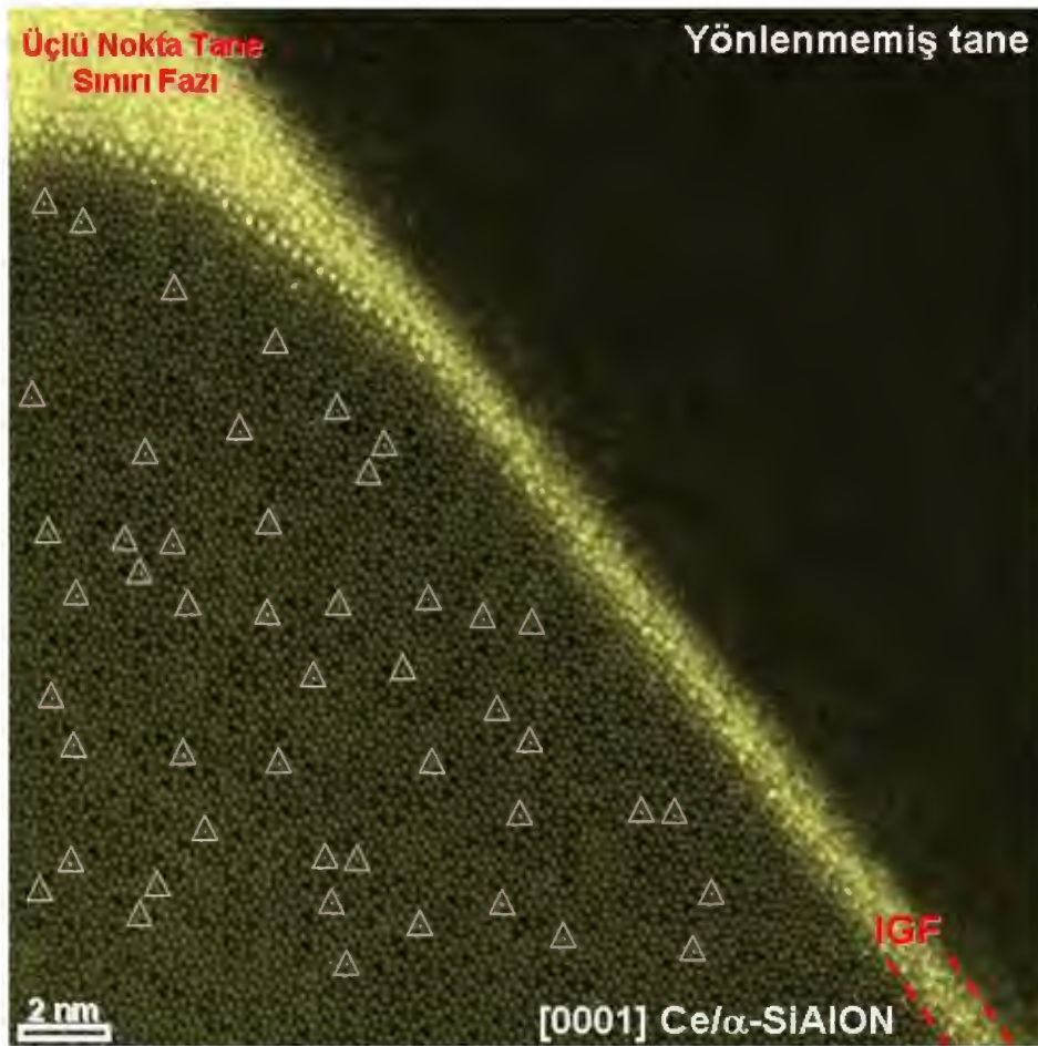
Şekil 9.17. \text{CeO}_2 ilaveli tek katyon sisteminde [0001] \alpha -SiAlON/IGF ve [0001] \alpha -SiAlON/amorf üçlü nokta tane sınırı ara-yüzeyini gösteren Z-kontrast UHR-STEM görüntüsü (Beyaz üçgenler \alpha -SiAlON kafesi içerisine giren Ce atomlarını göstermektedir).
