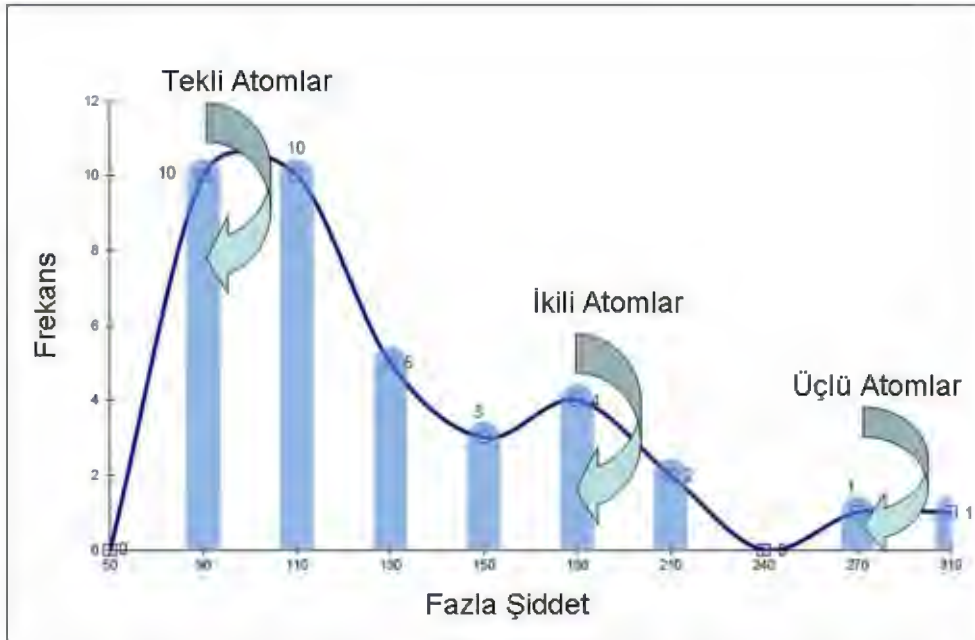
Şekil 8.10. [0001] Ce/α-SiAlON kafesindeki her bir ara-yer atomu için tespit edilen fazla şiddet değerlerinin histogram üzerindeki gösterimi.
