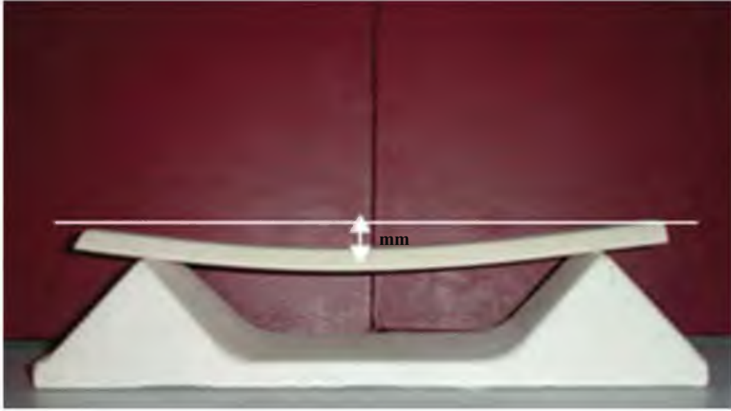
Şekil 3.5. Deformasyon ölçümü için test düzeneği
