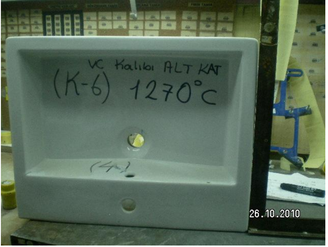
Şekil 6.11. K6 reçetesinden VC kalıbı kullanılarak üretilmiş ürün
