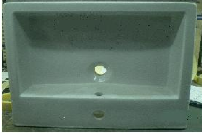
Şekil 6.6. Dik pozisyonda pişirim sırasında Vero lavabo
