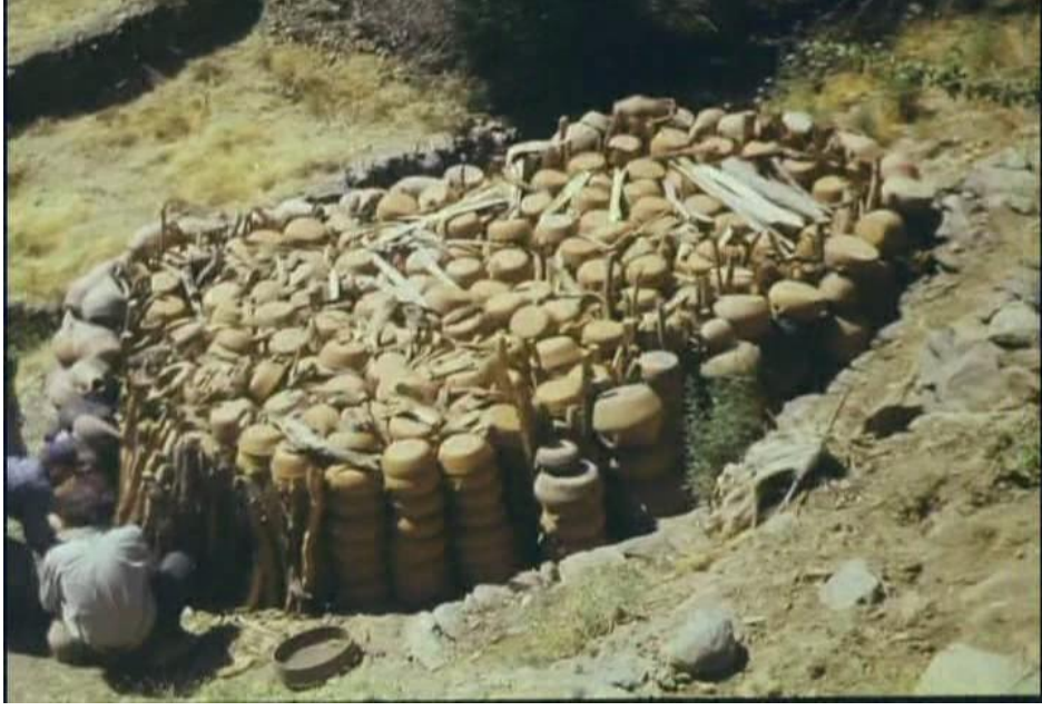
Şekil 5.9. Pişme öncesi ürünlerin yerleştirilmesi [50]
