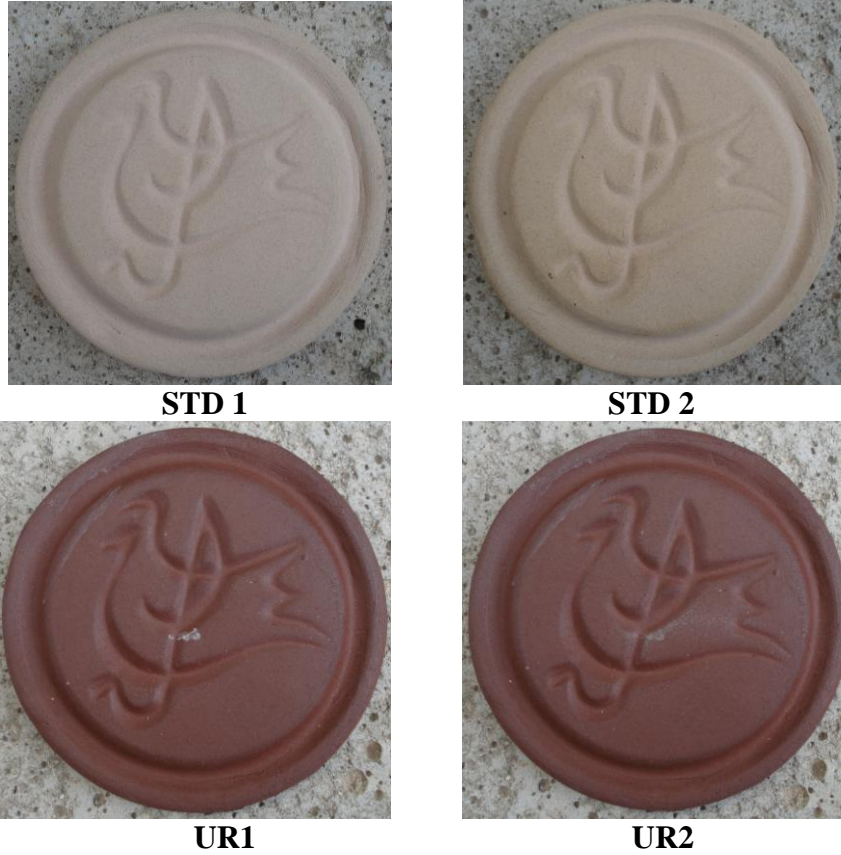
Şekil 7.11. Standart ve Uslu köyü kırmızı kili içeren bünyelerin sırsız yüzey görüntüleri
