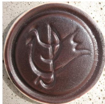
Şekil 7.13. Üleksit ve Uslu köyü kırmızı kili katkılı sırların 1160 °C 'deki pişme renkleri
