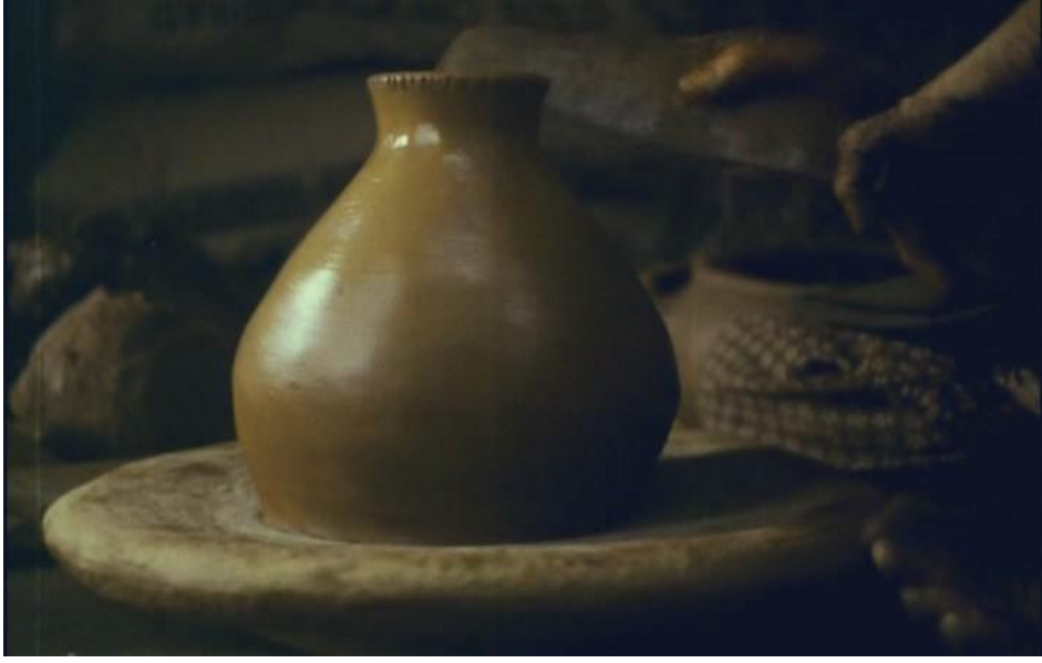
Şekil 5.8. Şekillendirme aşaması tamamlanmış ürün [50]
