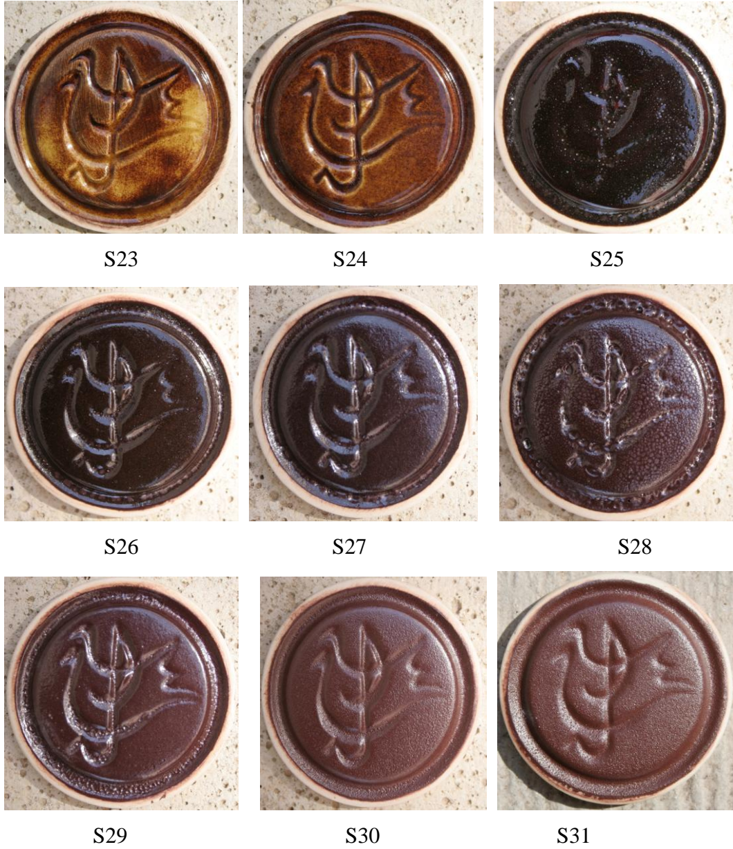
Şekil 7.15. Ticari firit -Uslu köyü kırmızı kil katkılı sırların 1160 0 C 'deki pişme renkleri
