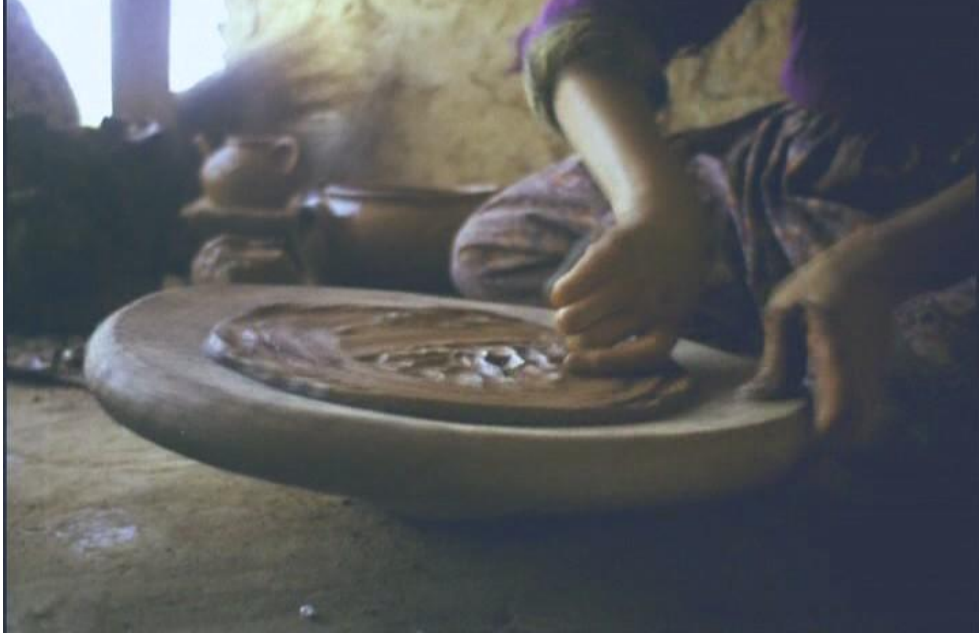
Şekil 5.5. Çömleğin tabanının açılma işlemi [50]
