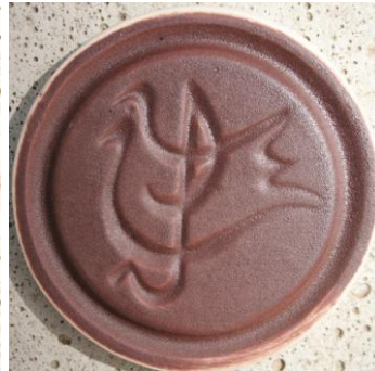
Şekil 7.13. Üleksit ve Uslu köyü kırmızı kili katkılı sırların 1160 °C 'deki pişme renkleri
