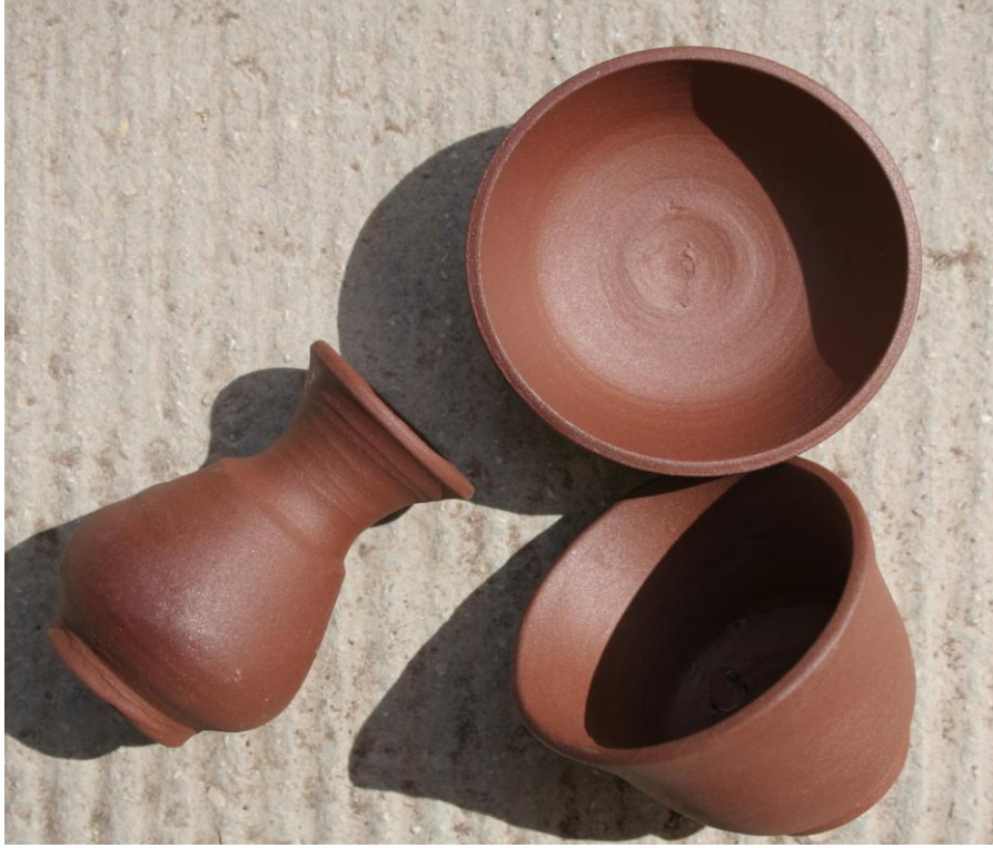
Şekil 7.7. Uslu köyü kırmızı kili ile tornada şekillendirilen formların 1160 °C'deki pişirim sonrası yüzey görünümleri
