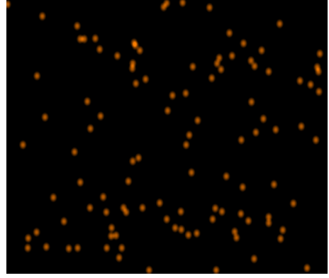
Şekil 12.12. M-%30S-%30SnO 2 refrakter malzemedeki korozyona uğrayan alanda refraktere yakın olan 3. Bölgenin element dağılımı
