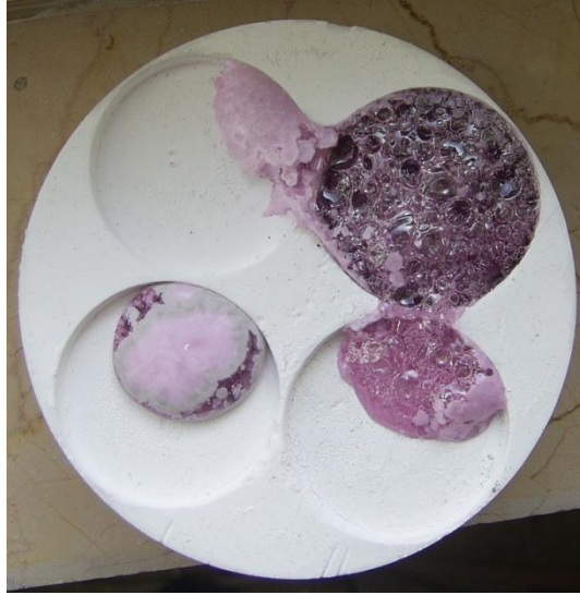
Şekil 4.1. Yüksek sıcaklığa maruz kalan camlardaki köpürme ve kristallenme
