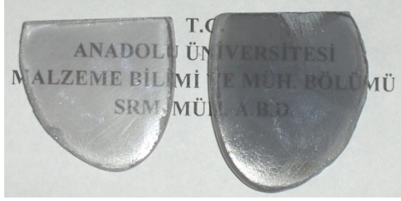
Şekil 4.41. Soğutma hızı ve safsızlıkların şeffaflığa etkisi. Soldaki cam atmosfere açık olarak, sağdaki ise BN toz içine gömülerek eritilmiştir.
