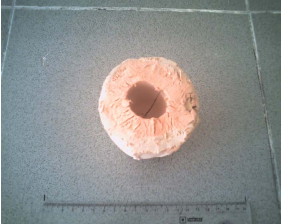
Şekil 6.10. S.M ( % 0,3 STPP'li ) döküm sonrası görüntüsü (a)
