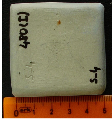
Şekil 5.35. SFD bünyesine ait ısı şok numunesi (50×50×5mm)
