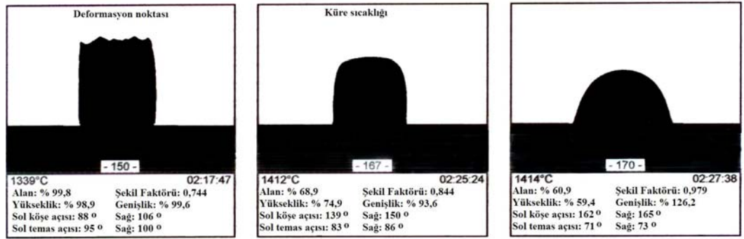
Şekil 6.5. Feldspat 637 ısı mikroskobu analizi
