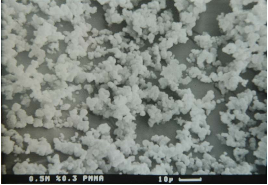
Şekil 5.7. % 0,3'lük Darvan C ilavesi ile elde edilen çökeleğin morfolojisi
