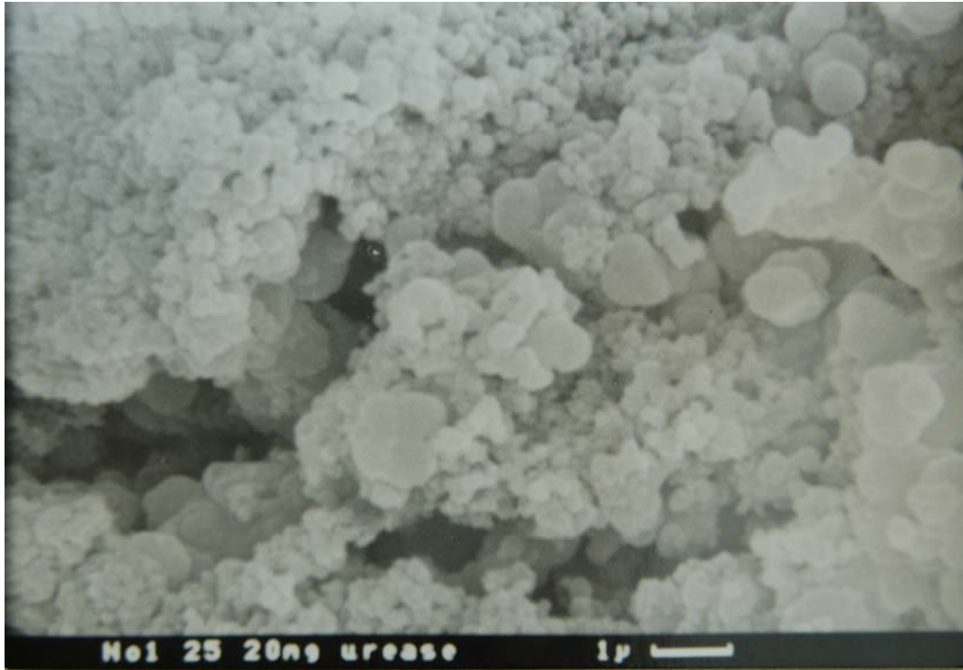
Şekil 5.9. Oda sıcaklığında 3.33 g alüminyum sülfat ve 6 g üre içeren çözeltiden elde edilen çökeleğin taramalı elektron mikroskobu fotoğrafı
