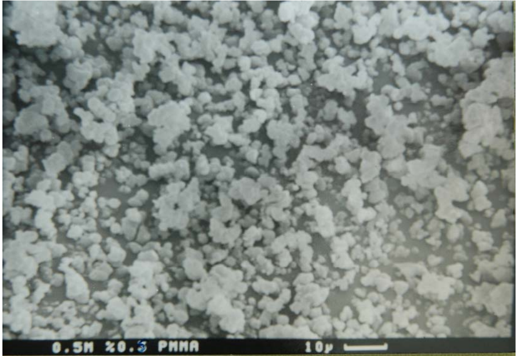
Şekil 5.8. % 0,5'lik Darvan C ilavesi ile elde edilen çökeleğin morfolojisi
