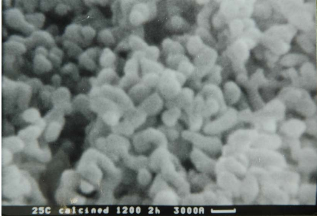
Şekil 5.13. Oda sıcaklığında çökeleklerin kalsinasyon sonrası taramalı elektron mikroskobu fotoğrafı
