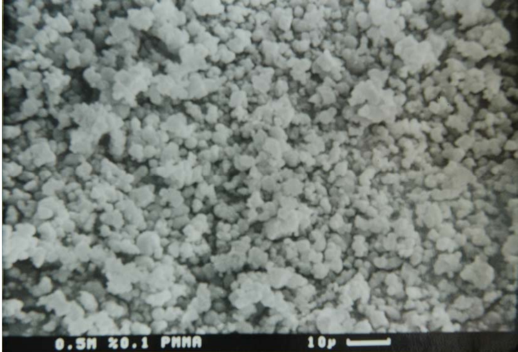
Şekil 5.6. % 0,1'lik Darvan C ilavesi ile elde edilen çökeleğin morfolojisi
