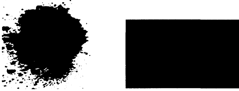
Şekil 4.10. Saf Fe_2O_3 ve Cr_2O_3 ile hazırlanan ve 1250 °C'de kalsine edilen siyah pigment tozları ve şeffaf sırda oluşturduğu renk
