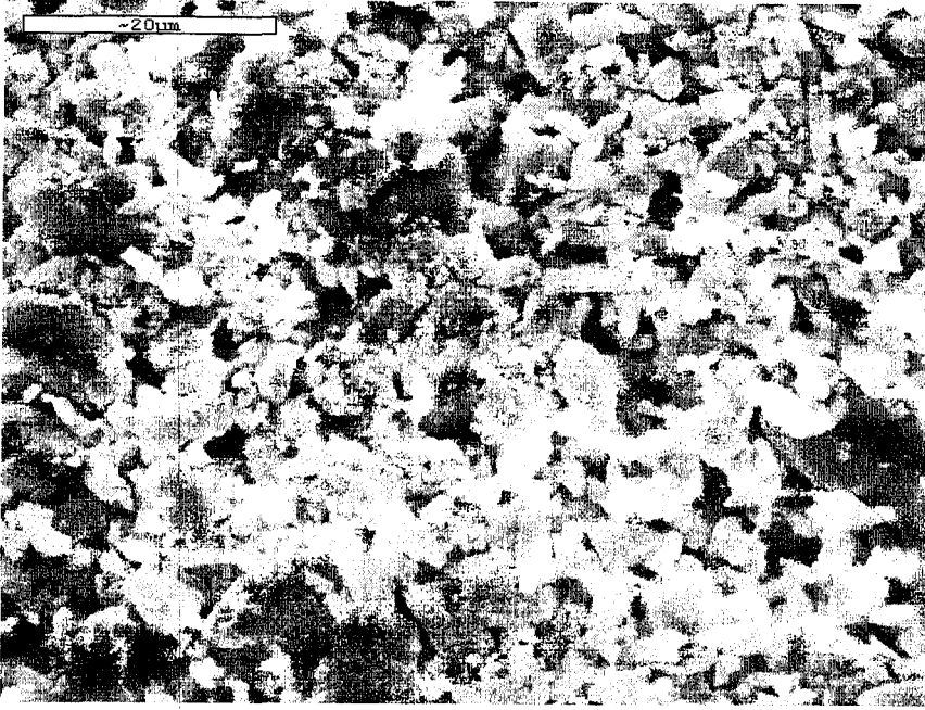
Şekil 6.14. % 1 \text{Li}_2\text{O}_3 ilaveli numuneden elde edilen ürünün Taramalı Elektron Mikroskobu (SEM) görüntüsü
