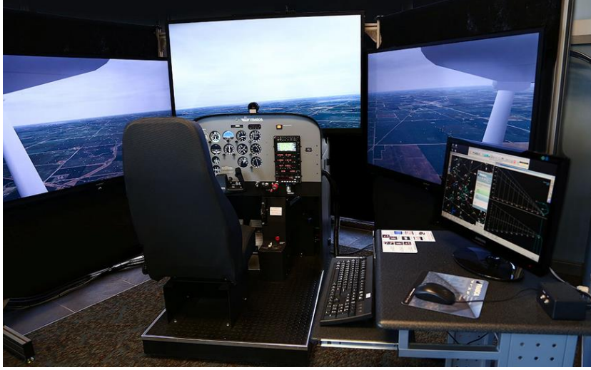
Şekil 1.12. Temel Aletli Uçuş Eğitim Cihazı (BITD) [43]
