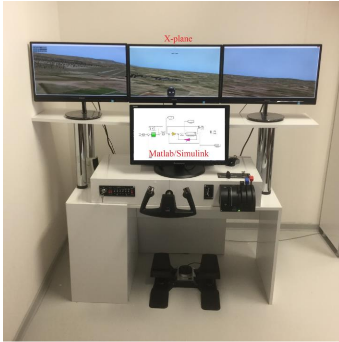
Şekil 3.10. Matlab/Simulink ve X-Plane Test/Geliştirme Platformu
