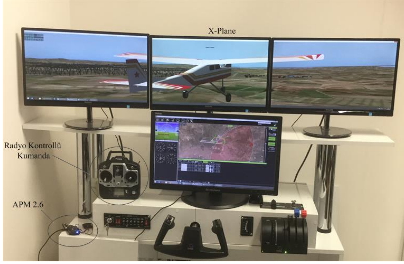
Şekil 3.4. Otopilot Test ve Geliştirme Ortamı
