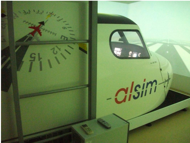
Şekil 1.11. Uçuş ve Seyrüsefer Prosedürler Eğitim Cihazı (FNPT), Anadolu Üniversitesi
