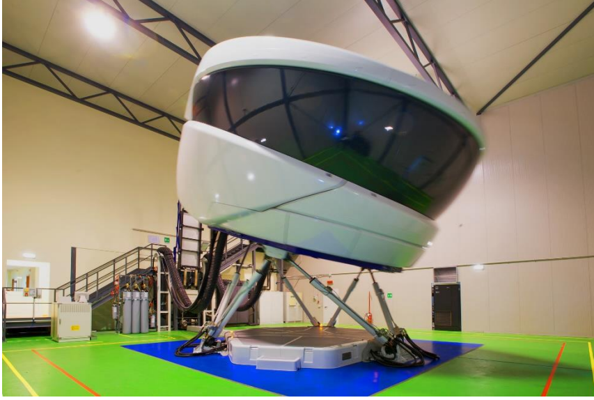
Şekil 1.9. Sukhoi Superjet 100 Tam Uçuş Simülatörü [37]
