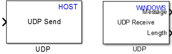
Şekil 3.8. Matlab/Simulink UDP Veri Gönderme ve Veri Alma Bloğu
