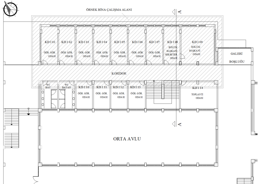
Şekil 3.5. Anadolu Üniversitesi Endüstri Mühendisliği Bölümü Akademik ve İdari Personel bloğu birinci kat planı
