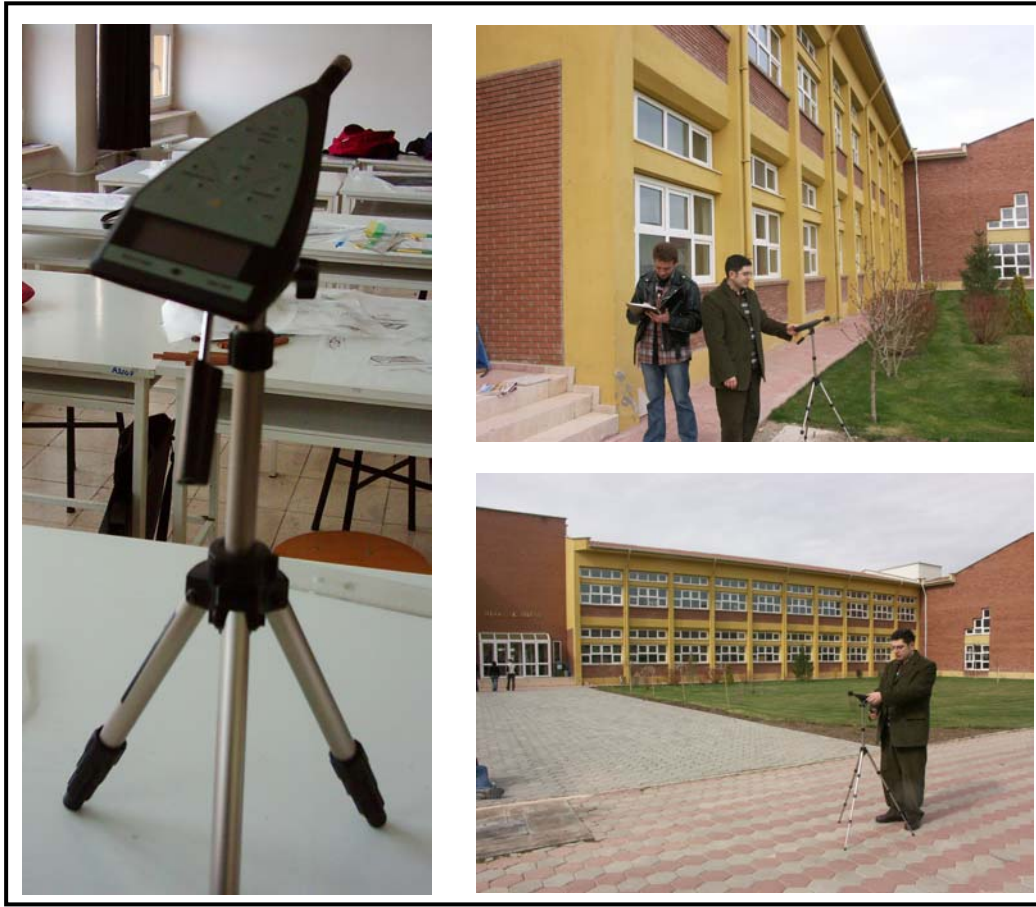
Şekil 4.17. Stüdyo 2 için yapı dışı gürültü düzeyi ölçmeleri
