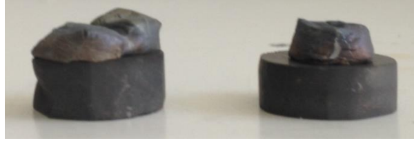
Görsel 3.4. 1000 °C'de 10 dakika sızdırma işlemine tabi tutulmuş numuneler
