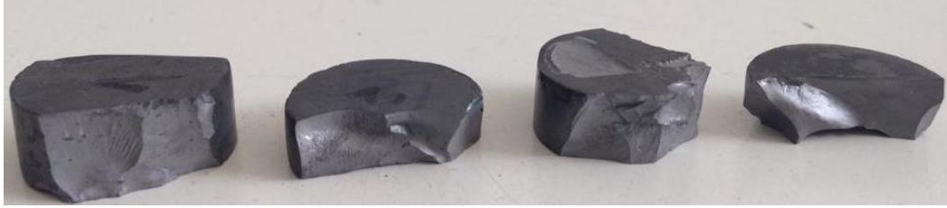
Görsel 3.5. 1100 °C'de 10 dakika sızdırma işlemine tabi tutulmuş numuneler
