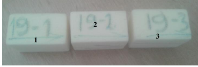
Şekil 7.18. Açık hücre oranı için hazırlanan köpük numuneleri
