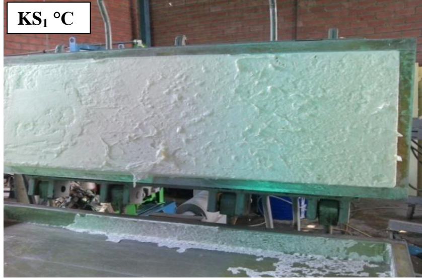
Şekil 8.6. KS_1 °C'lik kalıp sıcaklığında poliüretan köpük yüzeyi görünümü
