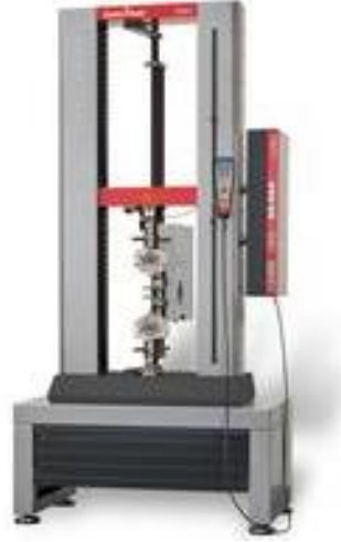
Şekil 7.5. Zwick Roell Proline basma mukavemeti ölçüm cihazı [50]
