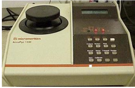
Şekil 7.19. Micromeritics AccuPyc 1330 piknometre cihazı [48]
