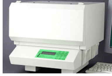
Şekil 7.1. Lasercomp FOX 314 ısı iletkenlik ölçüm cihazı [13]
