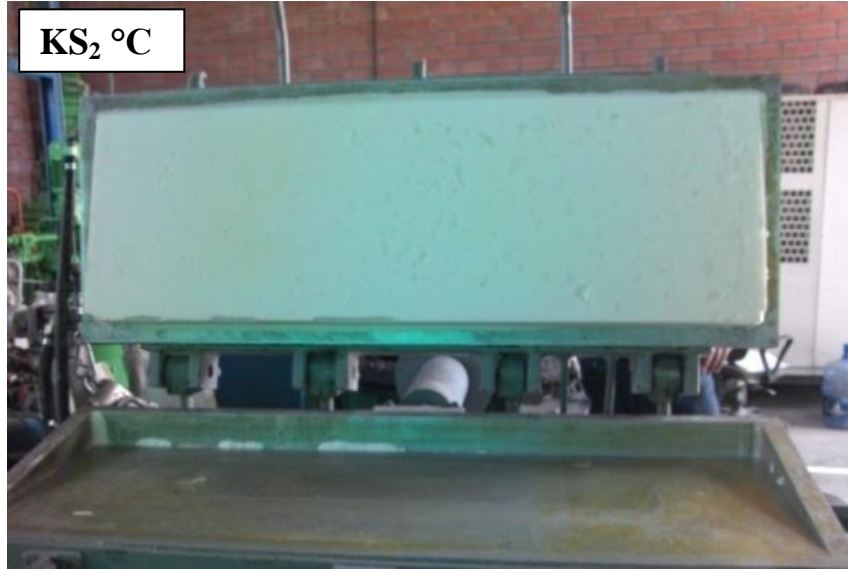
Şekil 8.7. KS_2 °C'lik kalıp sıcaklığında poliüretan köpük yüzeyi görünümü
