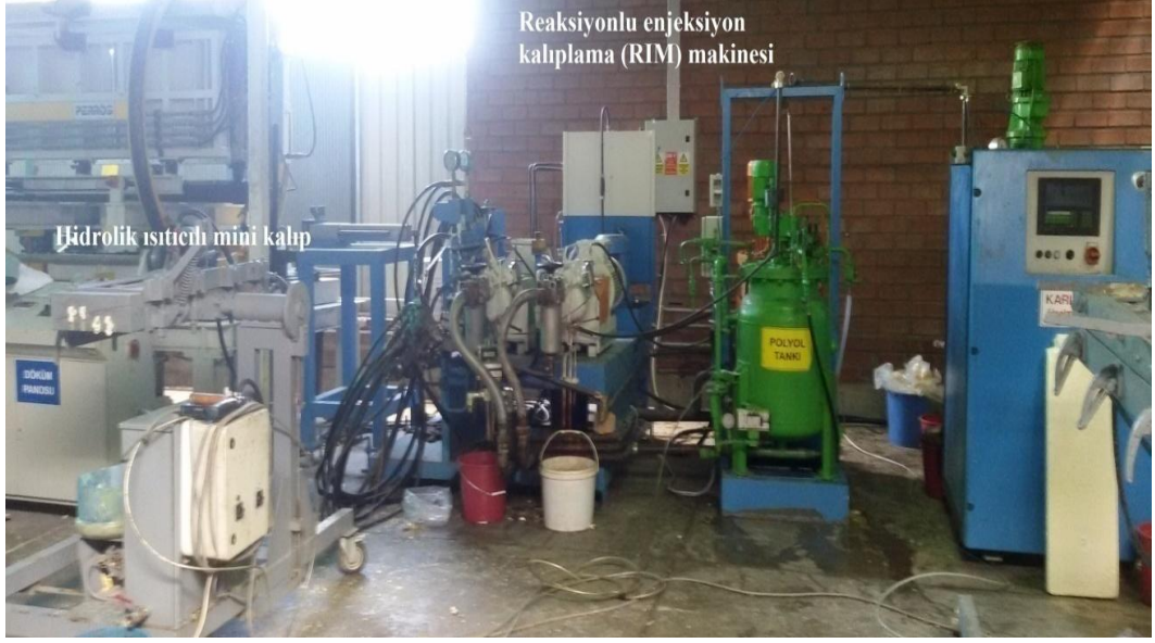
Şekil 7.11. Çalışmanın yapıldığı deneme sahası; reaksiyonlu enjeksiyon kalıplama (RIM) makinesi ve hidrolik ısıtıcı mini kalıp
