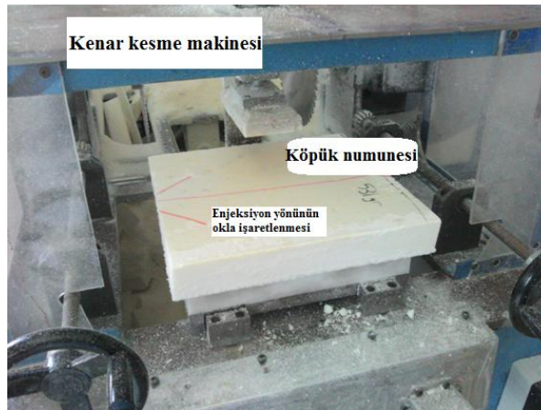
Şekil 7.14. Köpük kalıptan çıktıktan sonra ısıl iletim katsayısı ölçümü için hazırlanışı
