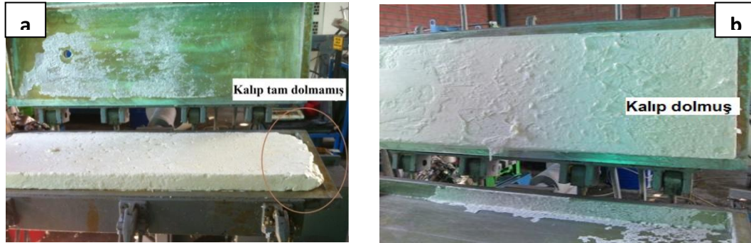
Şekil 8.22. (a) 20 nolu köpüğün görüntüsü; kalıp tam dolmamış (b) 21 nolu köpüğün görüntüsü; kalıp tam dolmuş
