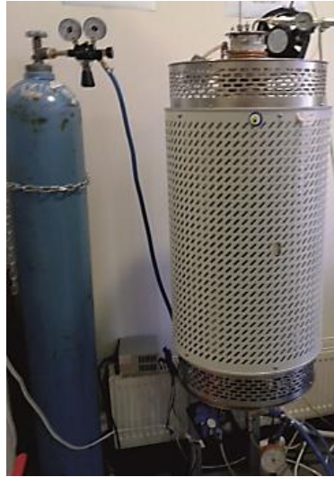
Şekil 3.1 Köpük malzeme üretiminde kullanılan atmosfer kontrollü dikey fırın
