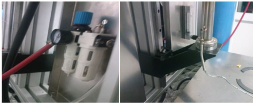
Şekil 5.3. Çemberi hareket ettiren pinömatik sistem
