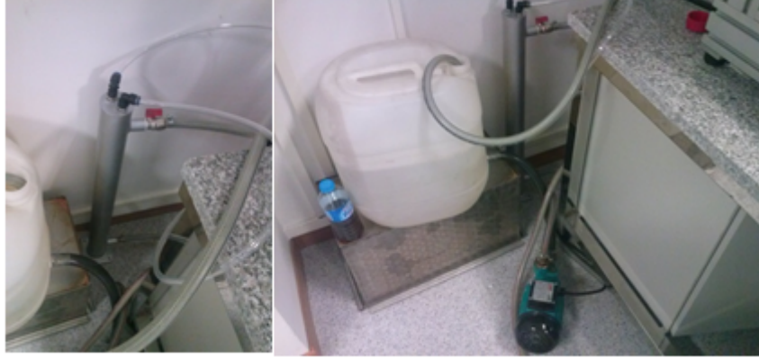
Şekil 5.5. Pompanın emme bölümüne eklenen soğutma kolonu
