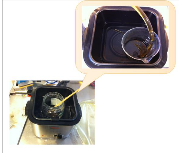
Şekil 2.10. Reçinenin proses sırasında ısıtılması
