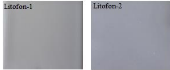
Şekil 5.22. 1120°C (Litofon-1) ve 1200°C'de (Litofon-2) tek pişirim yapılan ve %5 beyaz renkli pigment içeren sır uygulamaları
