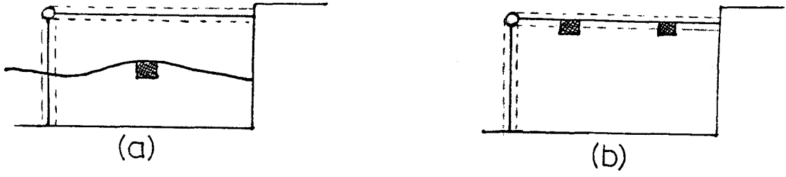
Şekil 4.12. Hidrolik kriko yuvasının hazırlanması a) Süreksizlik varsa b) Süreksizlik yoksa
