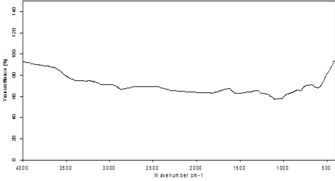
Şekil 6.13. Vakumlu Ortamda 750 °C’de Elde Edilen Aktif Karbonun FT-IR Spektrumu
