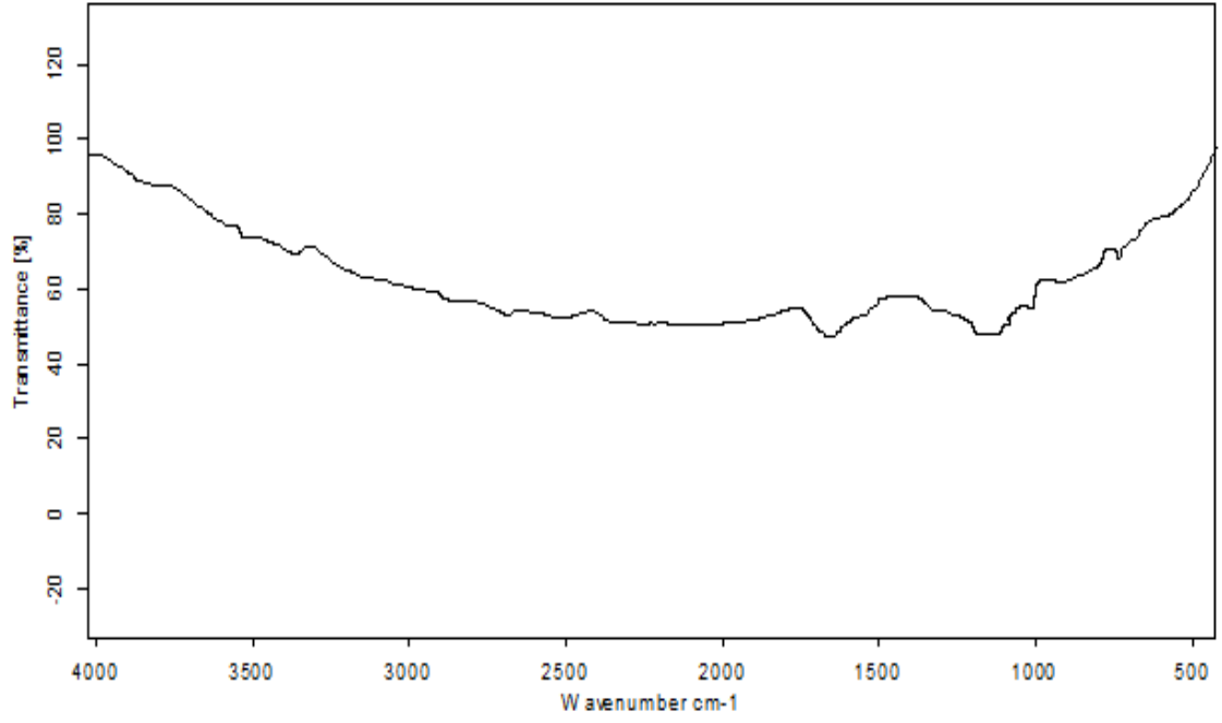
Şekil 6.9. Azotlu Ortamda 550 °C'de Elde Edilen Aktif Karbonun FT-IR Spektrumu
