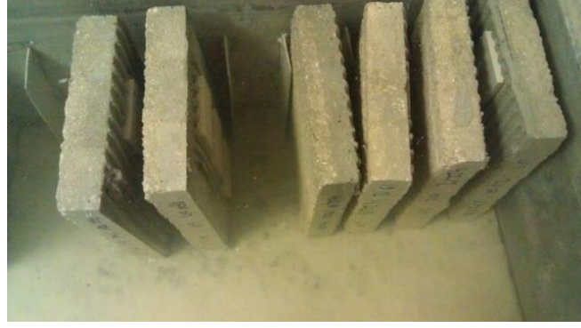
Görsel 8.12. Su temasından sonra çekme yapışma testi numuneleri
