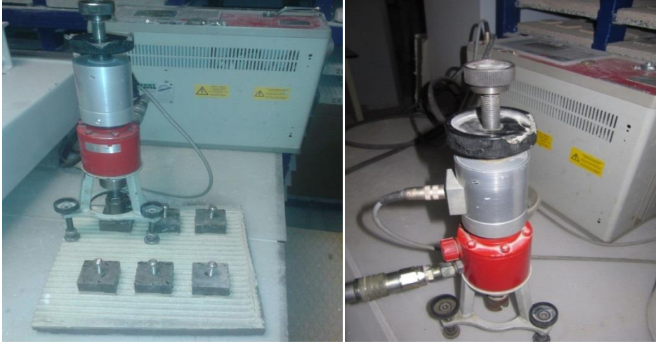
Görsel 8.2. Çekme koparma cihazı görüntüsü
