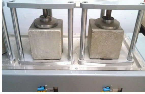
Görsel 8.14. Su basıncı dayanımı testi
