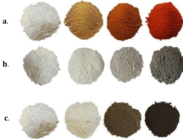
Şekil 7.3. Kuru emdirme yöntemi ile elde edilen sırasıyla %1, %5 ve %10'luk metal modifiye zeolitler a. Fe/ZSM-5, b. Ni/ZMS-5, c. Co/ZSM-5 zeolit
