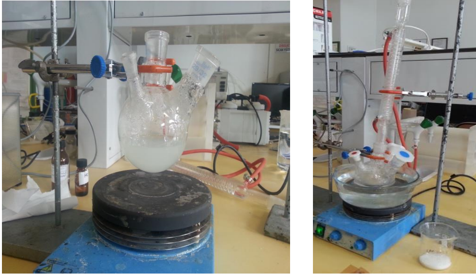
Şekil 8.1. Membran Çözeltisinin Hazırlanmış Olduğu Deney Düzenegi
