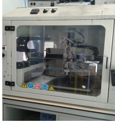
Şekil 8.3. Katalizör Hazırlanmasında Kullanılan Platin-Rutenyum- Karbon ve SONO-TEK Kaplama Cihazı
