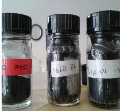
Şekil 8.3. Katalizör Hazırlanmasında Kullanılan Platin-Rutenyum- Karbon ve SONO-TEK Kaplama Cihazı
