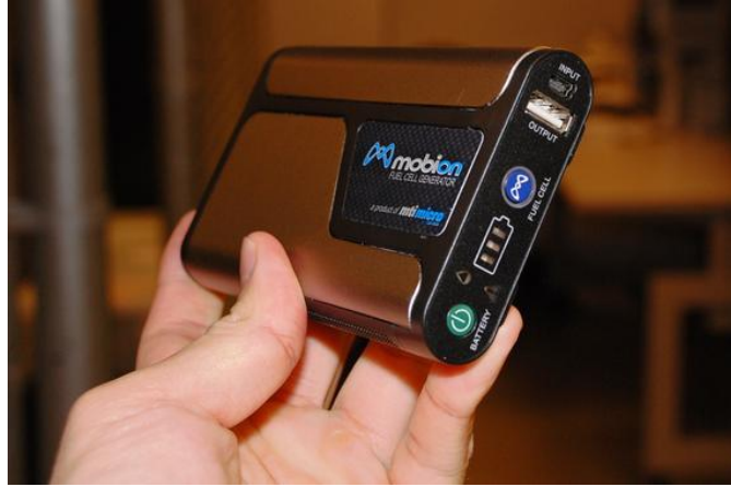
Şekil 4.3. MTI Micro Mobion Taşınabilir Metanol Yakıt Hücresi Güç İstasyonu [19]
