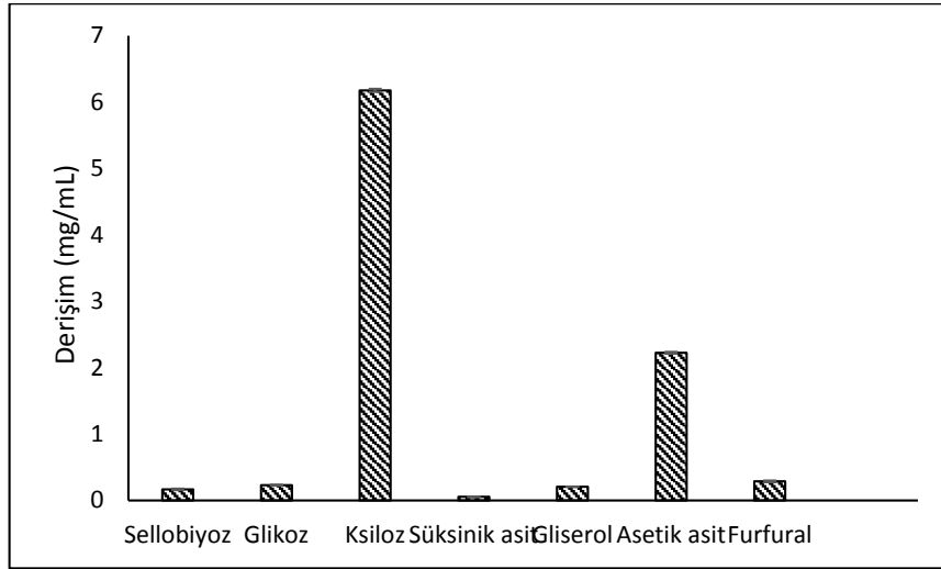
Şekil 4.20. 120 0 C’de, 1/10 katı/sıvı oranında 10 dak, %0,5 H 2 SO 4 ön işlem sıvısında bulunan bazı bileşikler
