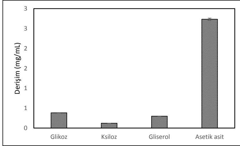
Şekil 4.94. 120°C, 1/10 katı/sıvı oranı, %4 NaOH içeren %50 EtOH ve 30 dak proses koşullarında ön işlem sıvılarının kimyasal bileşimi
