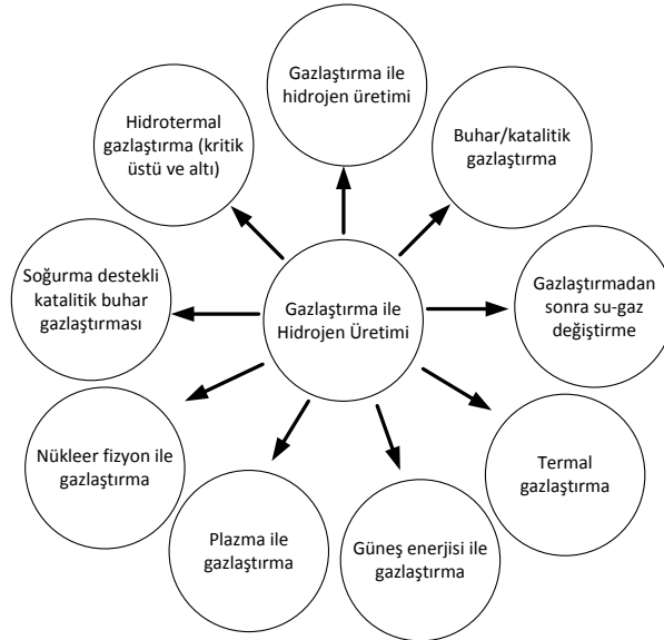
Şekil 3.5. Biyokütleden hidrojen üretimi için uygulanan farklı gazlaştırma teknolojileri (Bhaskar ve ark. 2013)
