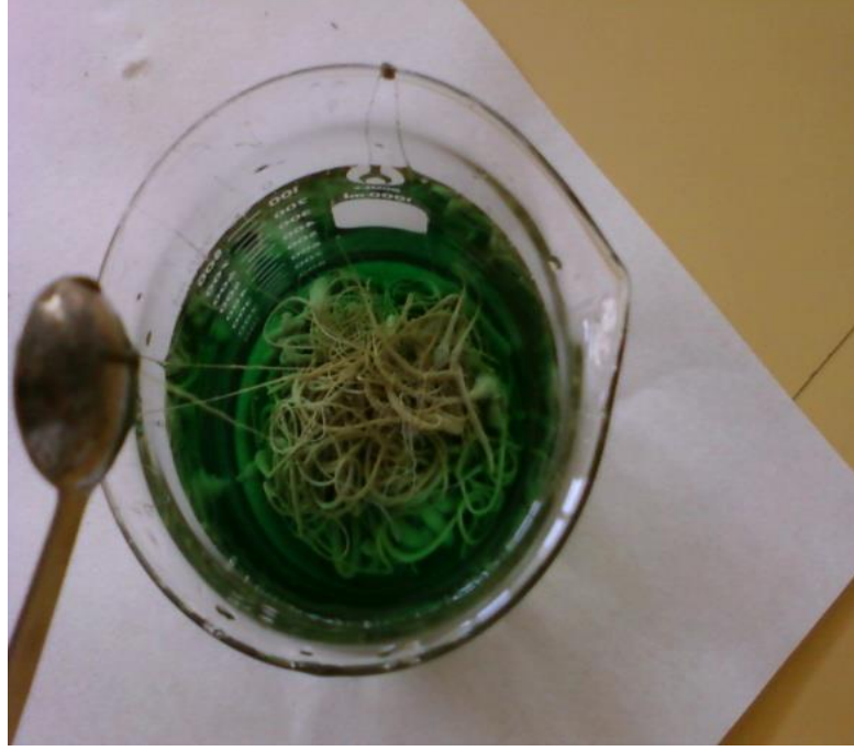
Şekil 5.2. Reaksiyon sonucunda üretilen PBI lifleri
