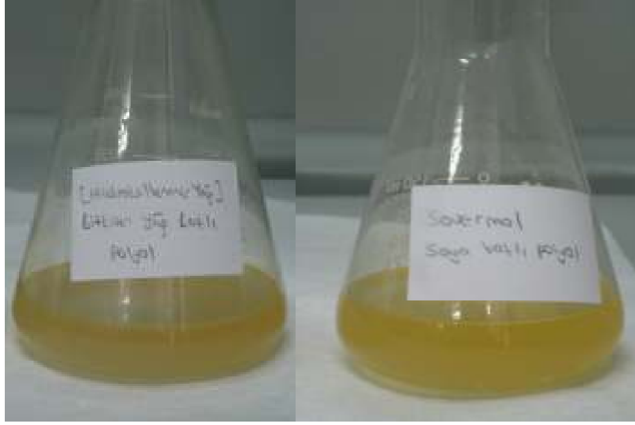
Şekil 7.3. Hidroksillenmiş Epoksi Yağ Numuneleri (Bitkisel Yağ Bazlı Polyol); (a) Laboratuvarda yapılan, (b) Ticari soya yağı bazlı polyol
