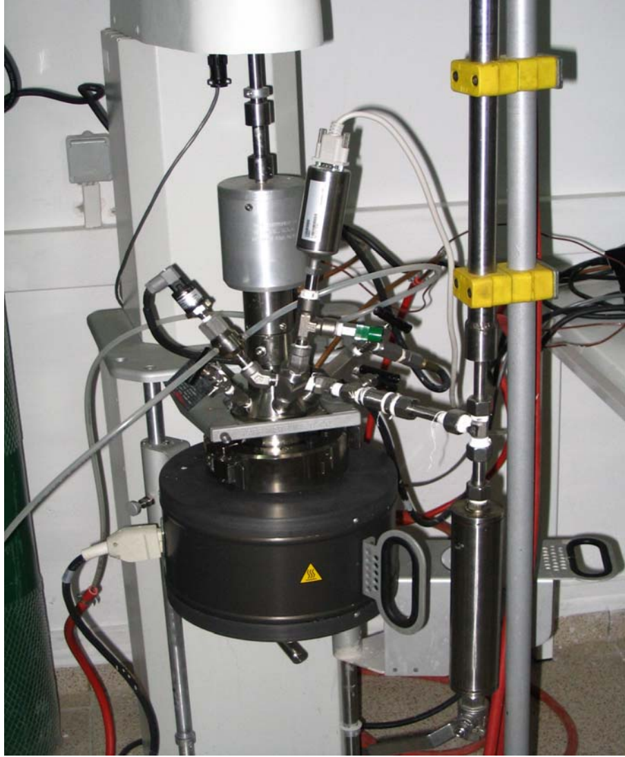
Şekil 3.2. Polimer sentezinde kullanılan paslanmaz çelik reaktör
