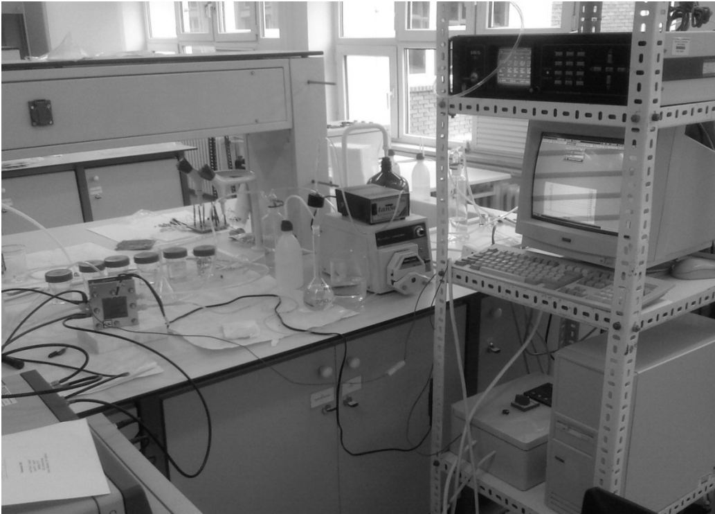
Şekil 7.3. Gaz Akış Hızı Ölçüm Birimi, Peristaltik Pompa, PID Kontrolör ve Bilgisayar
