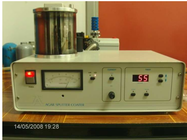
Şekil 7.5. Platin yüklemesi için kullanılan Agar Sputter Coater cihazı
