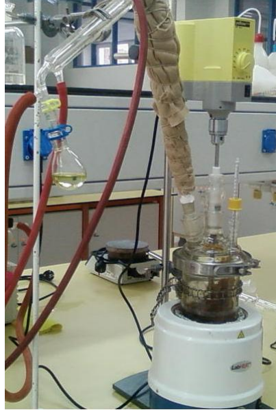
Şekil 3.7. Hint yağının ısıl parçalanmasında kullanılan cam reaktör sistemi
