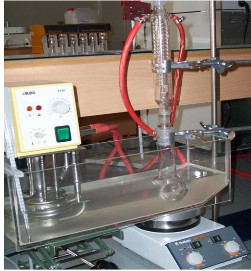
Şekil 3.4. Biyodizel çalışmalarında kullanılan su banyosu düzeneği
