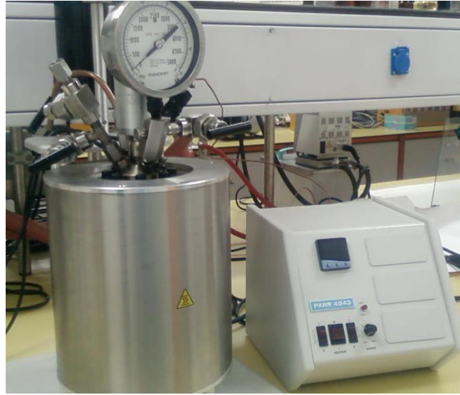
Şekil 3.5. Yüksek basınç-yüksek sıcaklık reaktörü (otoklav)
