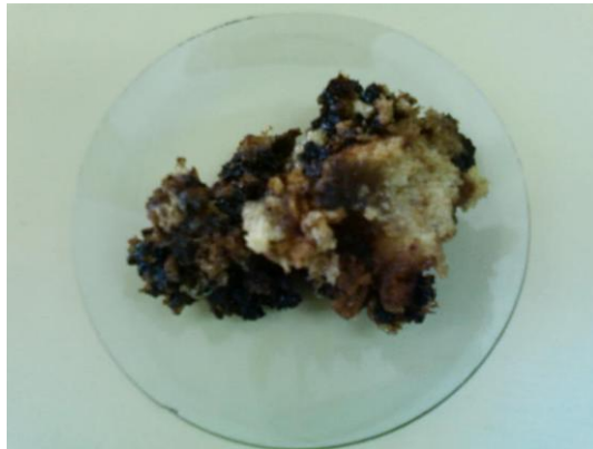
Şekil 4.2. Hint yağının cam reaktörde parçalanması sonucu elde edilen polimer yapı
