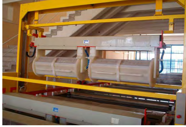
Şekil 4.3. Çinko Kaplama Prosesinde Kullanılan Dolap Sistemi
