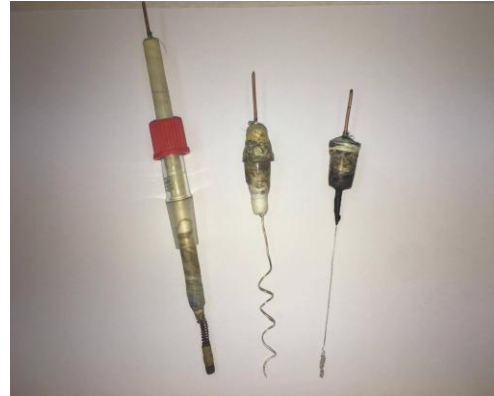
Şekil 3.1. (a) Çalışmada kullanılan potentiostat-galvanostat cihazı (b) deneylerde kullanılan üçlü elektrotlu sistemi ve (c) kullanılan elektrotların gösterimi (sırasıyla; çalışma, referans, karşıt elektrodu)
