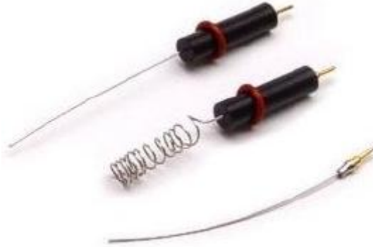
Şekil 2.27. Farklı şekillerde platin pseudo-referans elektrotları [123]
