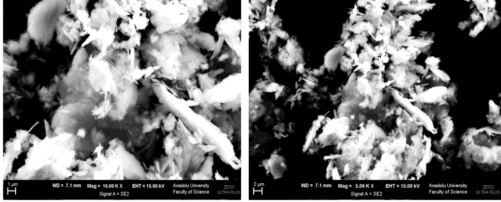
Şekil 4.14. Saf kaolinin SEM görüntüleri
