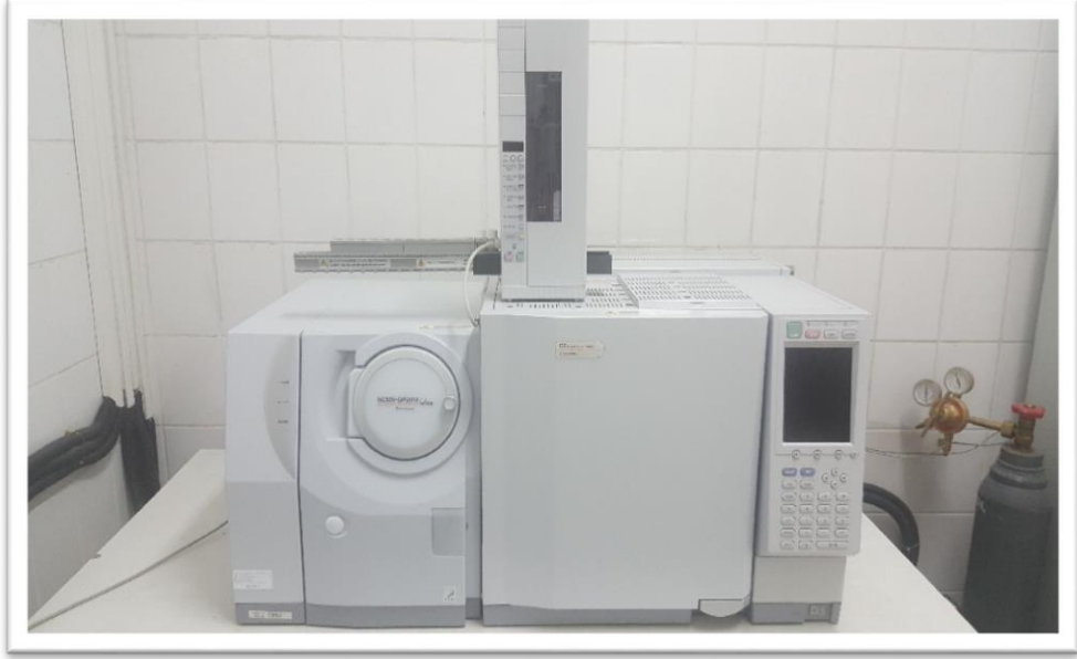
Şekil 3.5. Finnigan-PolarisQ, Thermo-Electron Corporation marka GC-MS cihazı
