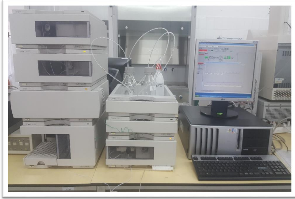
Şekil 3.4. Agilent 1100 marka HPLC cihazı
