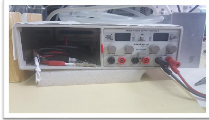
Şekil 3.2. Elektro-Fenton deneylerinde kullanılan akım sabitleyici
