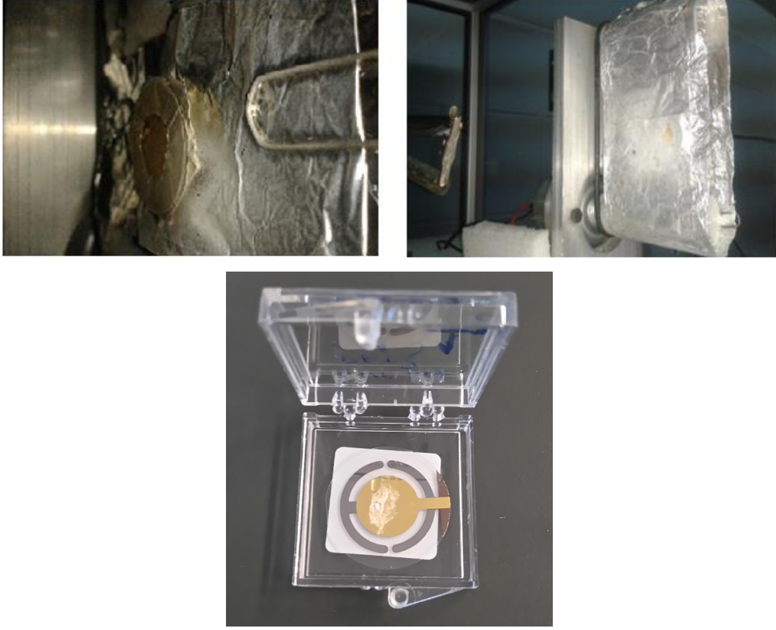
Şekil 3.4. QCM elektrot üzerinde elektroçekim işlemi ile nanofiber oluşumu ve kaplama sonrası QCM elektrodun fotoğrafı
