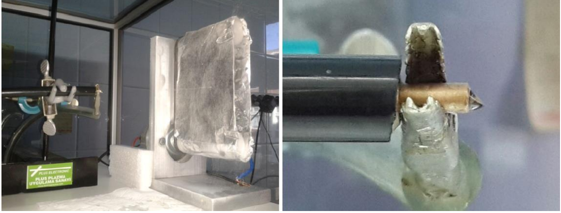
Şekil 3.2. 2,75 V elektrik alan içerisinde, 1,5 ml/sa hızında, 13 cm uzaklıkta alüminyum folyo üzerinde elde edilen nanofiberler
