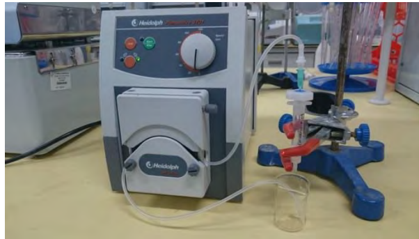
Şekil 2.4. Peristaltik pompa ile sürekli sistem
