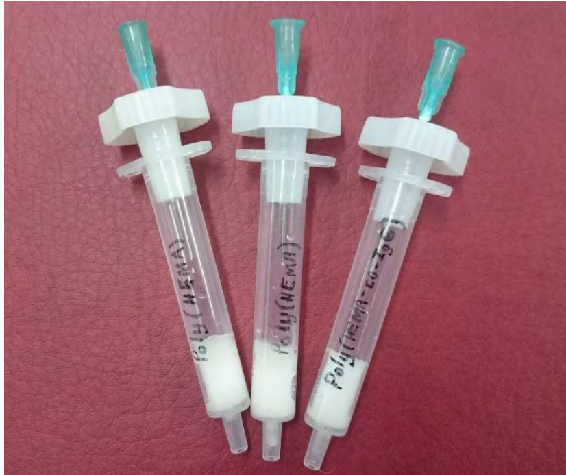
Şekil 2.1.Poli(HEMA) ve poli(HEMA-ko-IgG) kriyojel kolon
