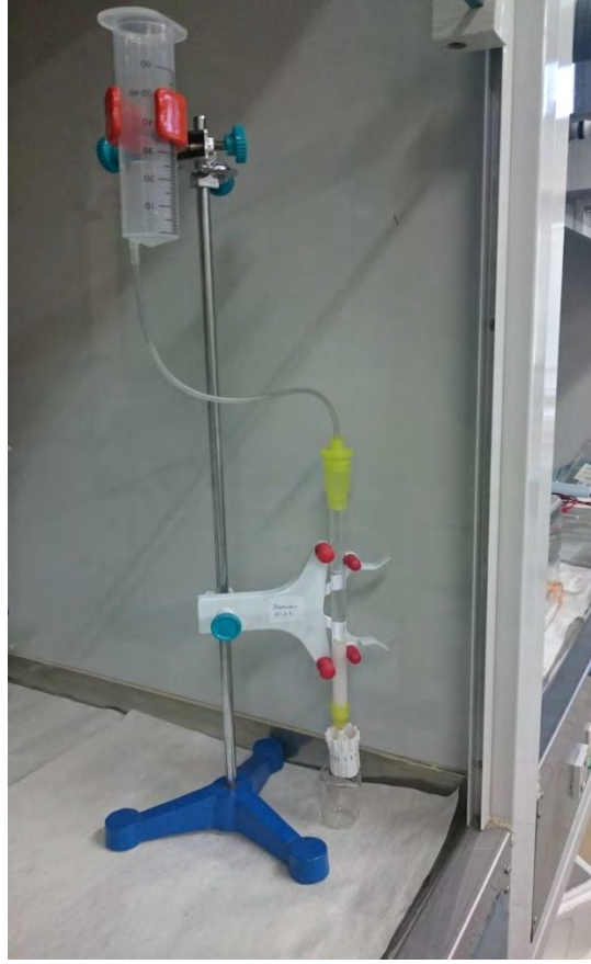
Şekil 2.6. Sphadex G-25 kolon sistemi
