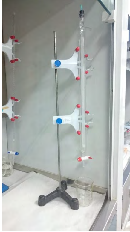
Şekil 2.7. Sephadex G-100 kolon sistemi
