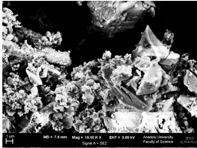
Şekil 6.1. Ön denemelerden elde edilen silikaya ait SEM görüntüsü [TEOS:formik asit= 1:4 mL; 280 bar, 55 °C, 5 sa]
