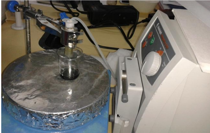
Şekil 4.16. 3. saat sonunda HRP bağlı fotosensitif kriyojel kolon kullanılan deney düzeneği
