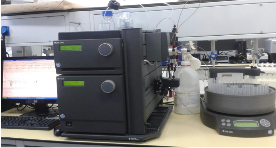
Şekil 3.1. Anadolu Üniversitesi Biyokimya Laboratuvarı FPLC cihazı
