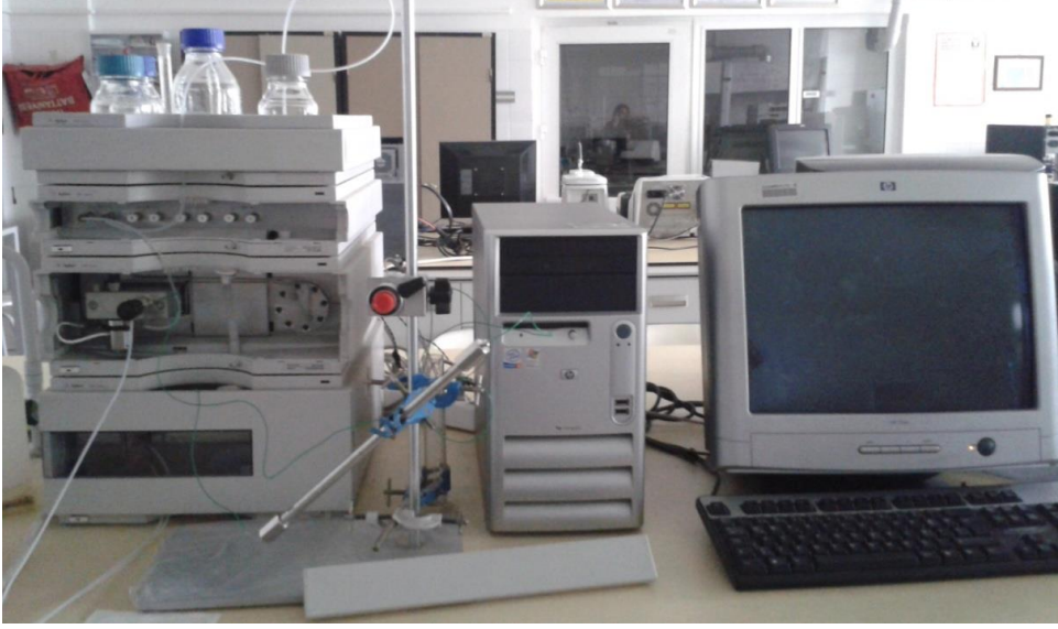
Şekil 3.7. Anadolu Üniversitesi Kromatografi Laboratuvarı GPC cihazı
