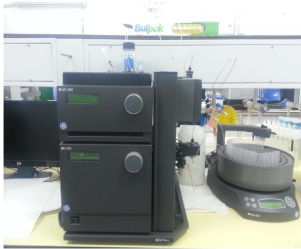
Şekil 3.3. Anadolu Üniversitesi Biyokimya Laboratuvarı FPLC cihazı
