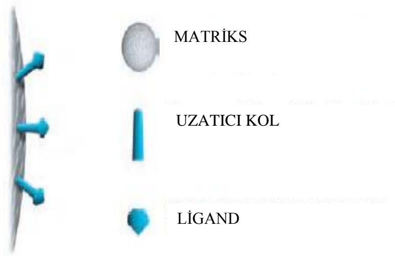
Şekil 2.16. Afinite kromatografisinin temel bileşenleri [59]
