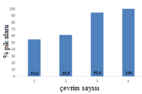
Şekil 3.40. 5 \times 10^{-4} mmol [FeTSPP] içeren heterojen katalizör ile katalizlenmiş TCP'nin (0,100 mmol) \text{KHSO}_5 (0,100 mmol) ile oksidasyonunda katalizörün 4 tekrar kullanılabilirlik deneyleri sonucunda reaksiyon ortamında kalan TCP % pik alanları
