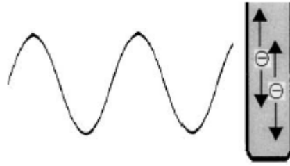
Şekil 2.5. Çözeltide bulunan yüklü parçacıkların değişen elektrik alanla etkileşimi ( Lidström, 2001).
