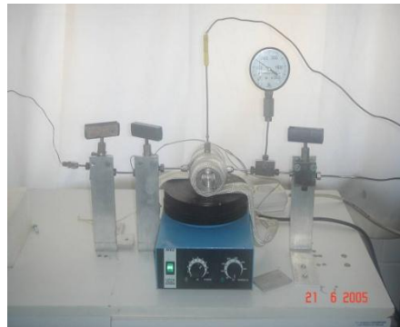
Şekil 2.7. Çözünlük testleri için kullanılan yüksek basınç reaktör sistemi
