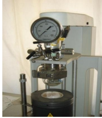
Şekil 2.9. Organik çözücü ortamında katalitik tepkimelerin yapıldığı cam reaktör
