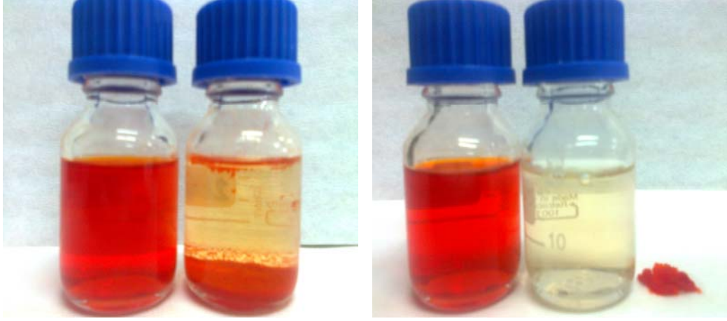
Şekil 3.18. p-VIm hidrojelinin OII adsorpsiyonundaki etkinliğini gösteren adsorpsiyon öncesi ve sonrasına ilişkin fotoğraflar. Deney koşulları: [Hidrojel]= 0,8 mg mL -1 , [OII]= 1000 mg L -1 , V_{\text{toplam}}= 25 mL, pH= 2,0.
