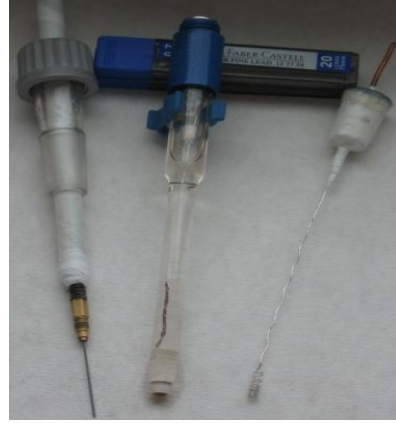
Şekil 4.1. (a) Çalışmada kullanılan Potentiostat-Galvanostat cihazı (b) Deneilerde kullanılan üç elektrotlu sistem (c) Kullanılan elektrotlar sırasıyla; çalışma, referans, karşıt elektrodu
