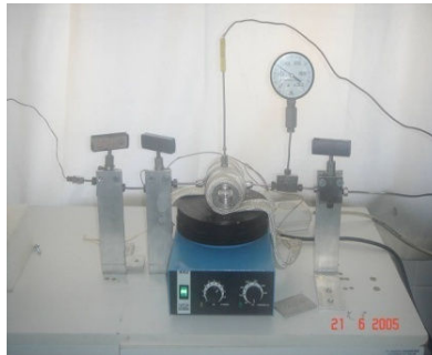
Şekil 2.7. Safir pencerele yüksek basınç reaktör sistemi
