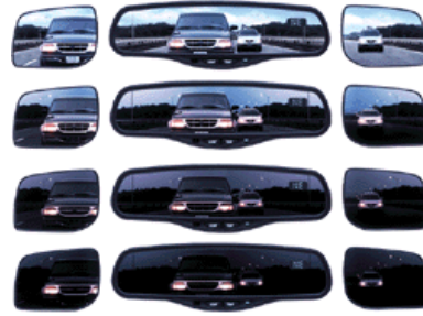
Şekil 2.8. Elektrokromik arka görüş (dikiz) aynalarında kararma
