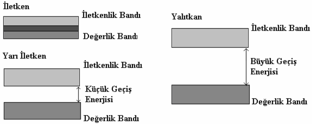
Şekil 1.4. İletken, yarı-iletken ve yalıtkan maddelerde band aralığı.
